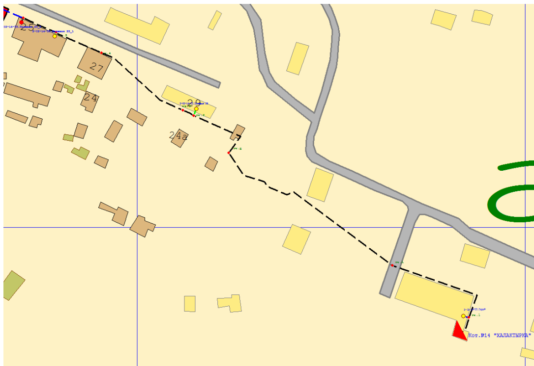
Рисунок 3.46-Результат гидравлического расчета - расчетный путь теплоносителя от Котельной №14 - "Халактырка до 2-02-14-ТП.Полевая 25_2.
