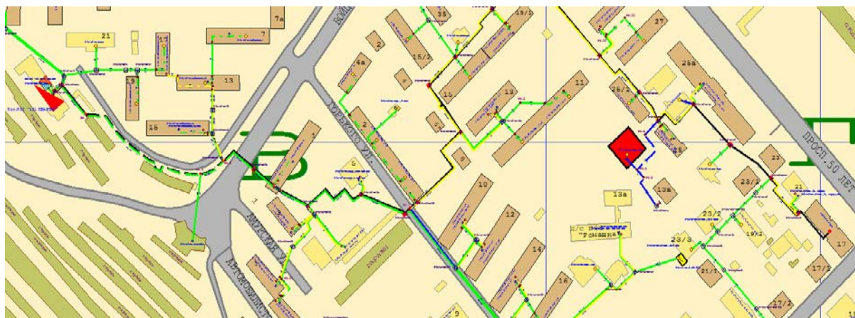
Рисунок 3.84-Результат гидравлического расчета - расчетный путь теплоносителя от Котельной №50 - "101 квартал" до 2-01-50-ТП.50-лет.,17 Пеликан
